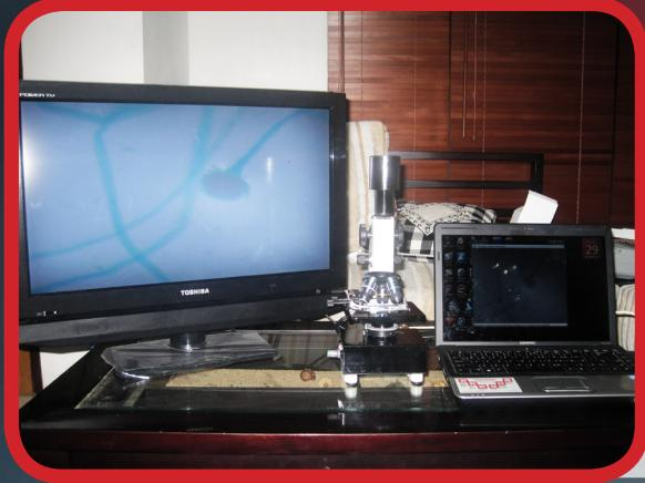
Mikroskop Multimedia, merupakan mikroskop xsp13A (mikroskop siswa lanjutan) yang diberi aksesori kamera beroutput usb dan video sehingga memungkinkan siswa dapat menggunakan mikroskop ini secara optimal. Output usb ditujukan untuk menyimpan baik gambar (image) maupun film (movie) dengan menggunakan laptop atau PC (personal computer) spek rendah sekalipun, sedangkan output video memungkinkan siswa untuk melihat hasil pengamatan secara langsung melalui LCD, TV atau proyektor
